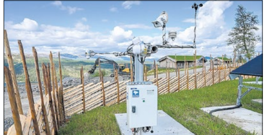
SAMLER DATA: Denne værstasjonen samler data om det meste som berører produksjon av solenergi på Gålå.
